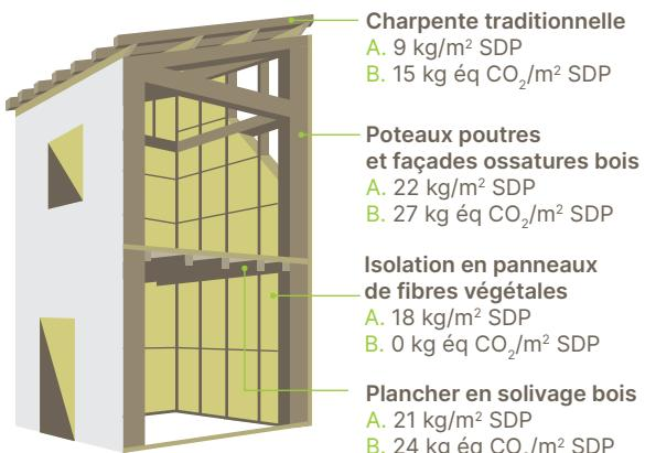
Extension 200 m<sup>2</sup> en ossature bois et toit terrasse en CLT
